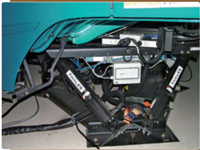
A jármű mozgását utánozó fülkemozgató egység
