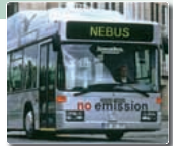
Az 1997-ben bemutatott Nebusszal (New Electric Bus) demonstrálta a Daimler a tüzelőanyag-cellás hajtás alkalmazásának lehetőségét városi buszokban. Hatótávolsága 250 kilométer, és könnyen teljesíti így a szokásos vonali buszok napi feladatát
