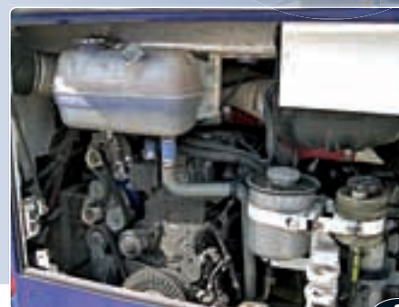
1. A konferencián bemutatott szlovák gyártmányú autóbuszok 2. A végig alacsonypadlós utastér 3. A vezető munkahelye 4. Az erőforrás álló beépítésű hathengeres Cummins motor
