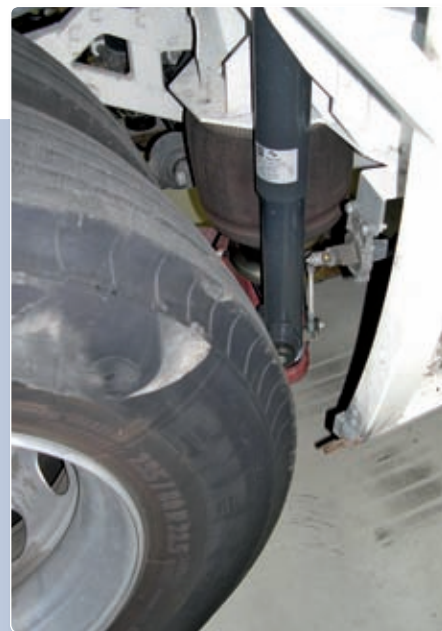
Az elektronikus légrugó-rendszer szintérezkelője és légrugója
