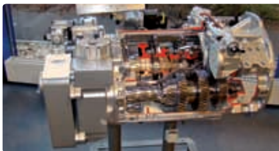
Az új típusú váltómű metszeti darabja, és a kezelőszerve a műszerfalon
