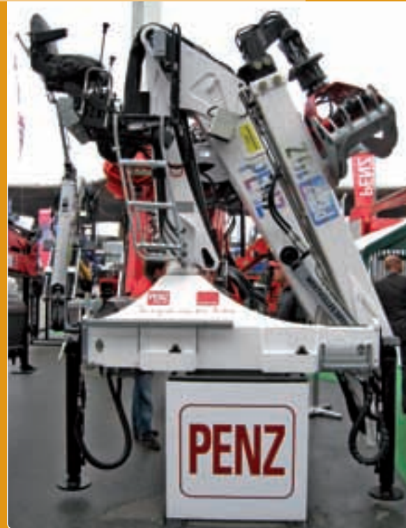
PENZ 10-Z daru, új típus. A fejlesztőknek sikerült a komolyabb erősítést súlynövekedés nélkül megoldani
