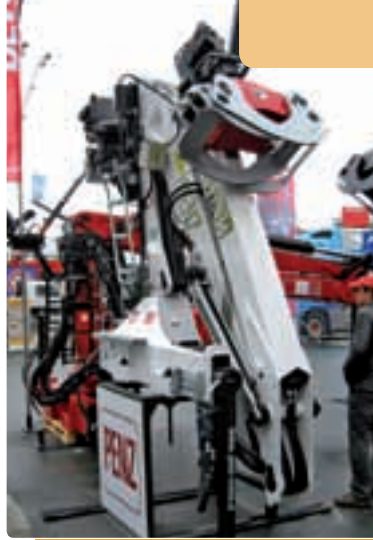
PENZ 10-Z daru, új típus. A fejlesztőknek sikerült a komolyabb erősítést súlynövekedés nélkül megoldani
