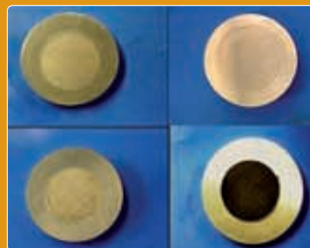
A régi és új hűtőfolyadék korróziós tulajdonsága – a bal oldalon nincs elválás, a jobb oldalon látványos a lerakódás
