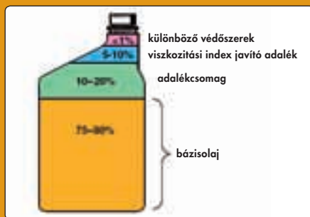
A motorolaj összetevői és minőségjavító adalékok a különböző összetevők fejlesztésében
