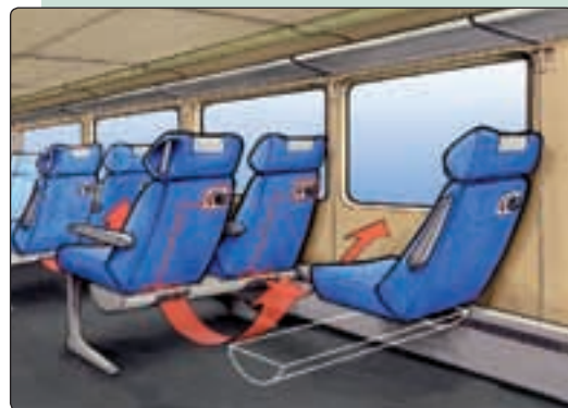
Az egyedi temperálás grafikája. Ezzel a módszerrel a padló rész gyorsan felmelegszik. Meleg láb, hideg fej – nemcsak a járművezetőnek, hanem az utasnak is feltétel a kellemes hőérzet
