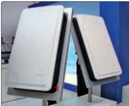
A finnországi Turkuban készülnek a Spheros-Parabus tetőablakok. Az új Elexx nevű termékek könnyűek, stabilak, jól szigetelnek, nyitásával új standardot jelentenek
