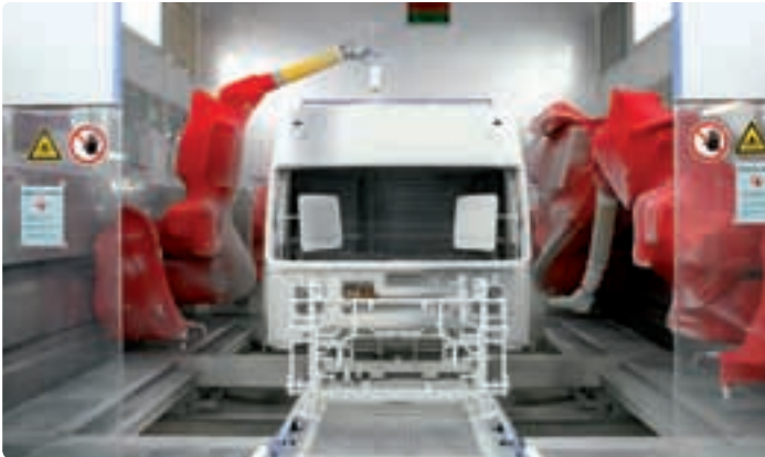
Felületkezelés, KTL, az üregek viaszos védelme... a korrózió ismeretlen fogalom Wörthben
