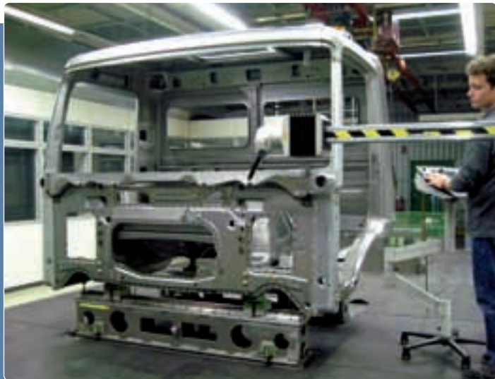
A fülke első, igen komoly megmértetése, 300 mérési pont van, a mérés ideje akár 90 perc is lehet
