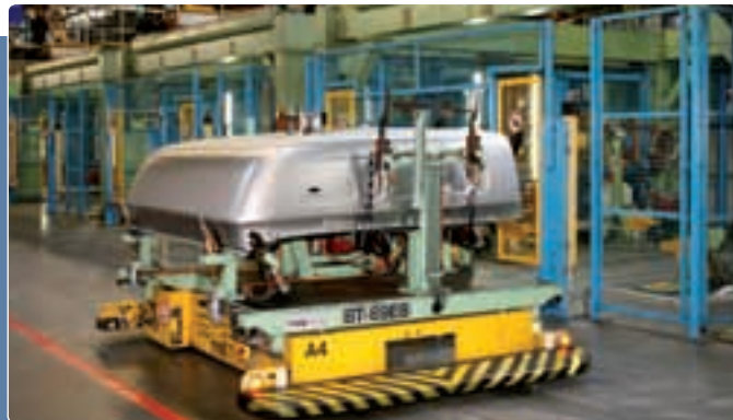
A fülke karosszériaelemének mozgatása emberi közreműködés nélkül történik
