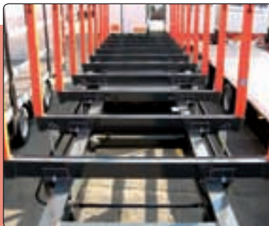
Farönkszállító félpótkocsi – egyre nagyobb az érdeklődés a padló nélküli kivitelek iránt
