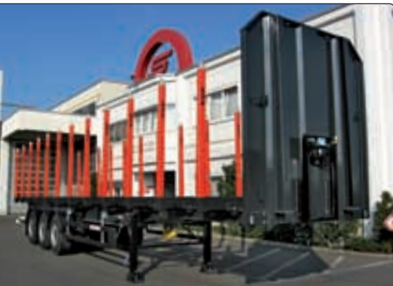
Farönkszállító félpótkocsi – egyre nagyobb az érdeklődés a padló nélküli kivitelek iránt
