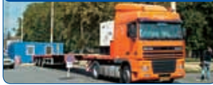
hosszúanyag-szállító, minden tengely hidraulikusan kormányzott, 13,6 m-ig széthúzható, 15,4 m rz.
