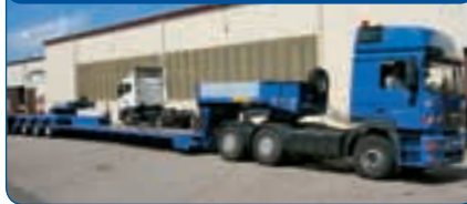
hosszúanyag-szállító, minden tengely hidraulikusan kormányzott, 13,6 m-ig széthúzható, 15,4 m rz.
