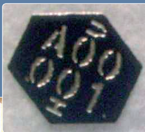
Azonosító, csak speciális nagyítóval látható, és UV érzékeny fedőlakk védi
