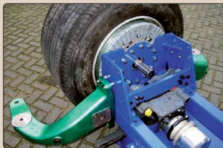
Kerékagymotoros hajtás – egyes gumiabronccsal a hajtott tengelyen (e-Traction)
